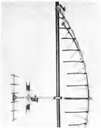
Bild 1. Parabol-Fernsehantenne mit hohem Gewinn für alle Kanäle der Bereiche IV und V (Dipola). Die untere Hälfte (die wir wegen des knappen Raumes nicht zeigen) sieht genau wie die obere aus
