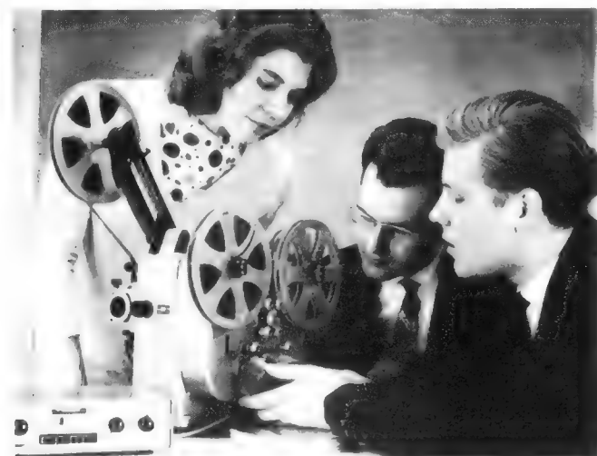
Für den Siemens-8-mm-Projektor 800 steht dem Amateur jetzt auch ein Tonlaufwerk für lippen-synchrone Vertonung zur Verfügung. Das komplette Tonlaufwerk ist in einem Baustein zusammengefaßt und läßt sich mit wenigen Handgriffen an jedem Projektor 800 anbringen. Der dazugehörige Aufnahme- und Wiedergabeverstärker hat zwei Watt Leistung
