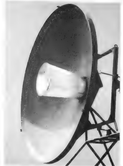
Bild 7. 4-GHz-Parabolantenne mit Doppelreflektor für gleichzeitige horizontal und vertikal polarisierte Abstrahlung nach dem Cassegrain-Prinzip (Telefunken)
