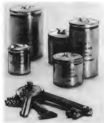
Bild 2. MKY-Kondensatoren im Metallbecher mit einem Keramikdeckel. Der Wickel besteht aus metallisiertem Kunststoff auf Styrolbasis (Siemens)
