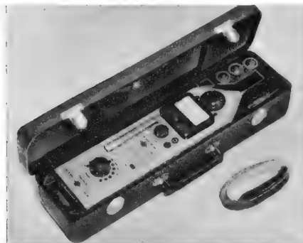
Bild 17. Tragbarer Schallpegelmesser Typ 2203 mit unten angestecktem Oktavfilter (Brüel & Kjaer)
