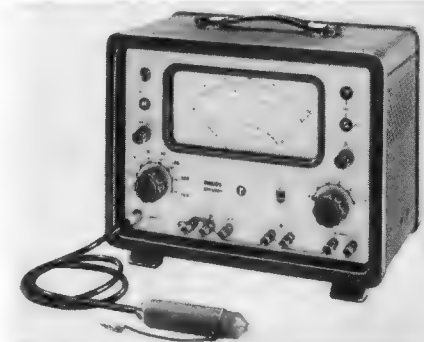
Bild 1. Vielfachinstrument Multiscript 3 mit eingebautem Schreiber (Metrawatt)
