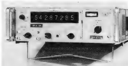
Bild 12. Achtstelliger Frequenzzähler mit Zeitintervall-Meßgerät für 0 bis 50 MHz; rechts ist ein Einschub für Messungen bis 100 MHz eingeschoben (Hewlett-Packard)
